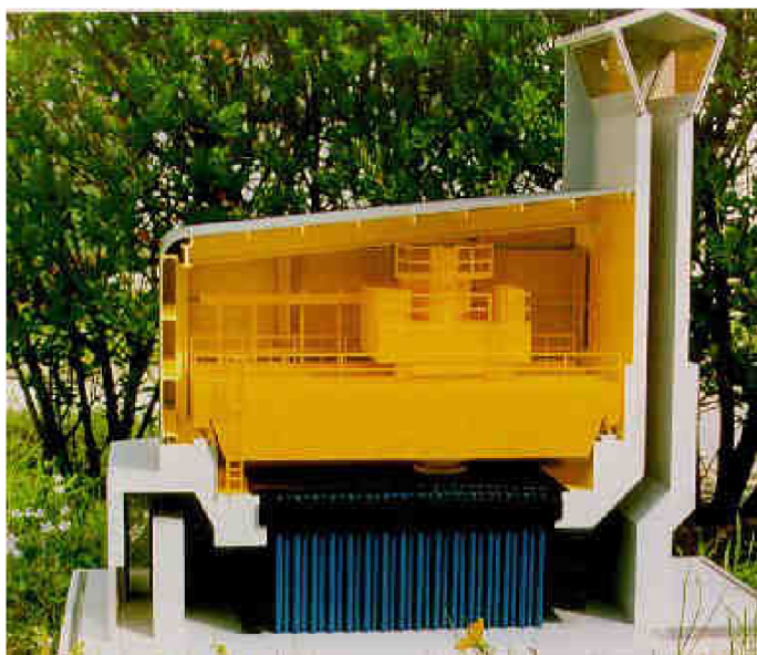
Obrázek 20 Svislý řez modelem skladu Paks [25]
