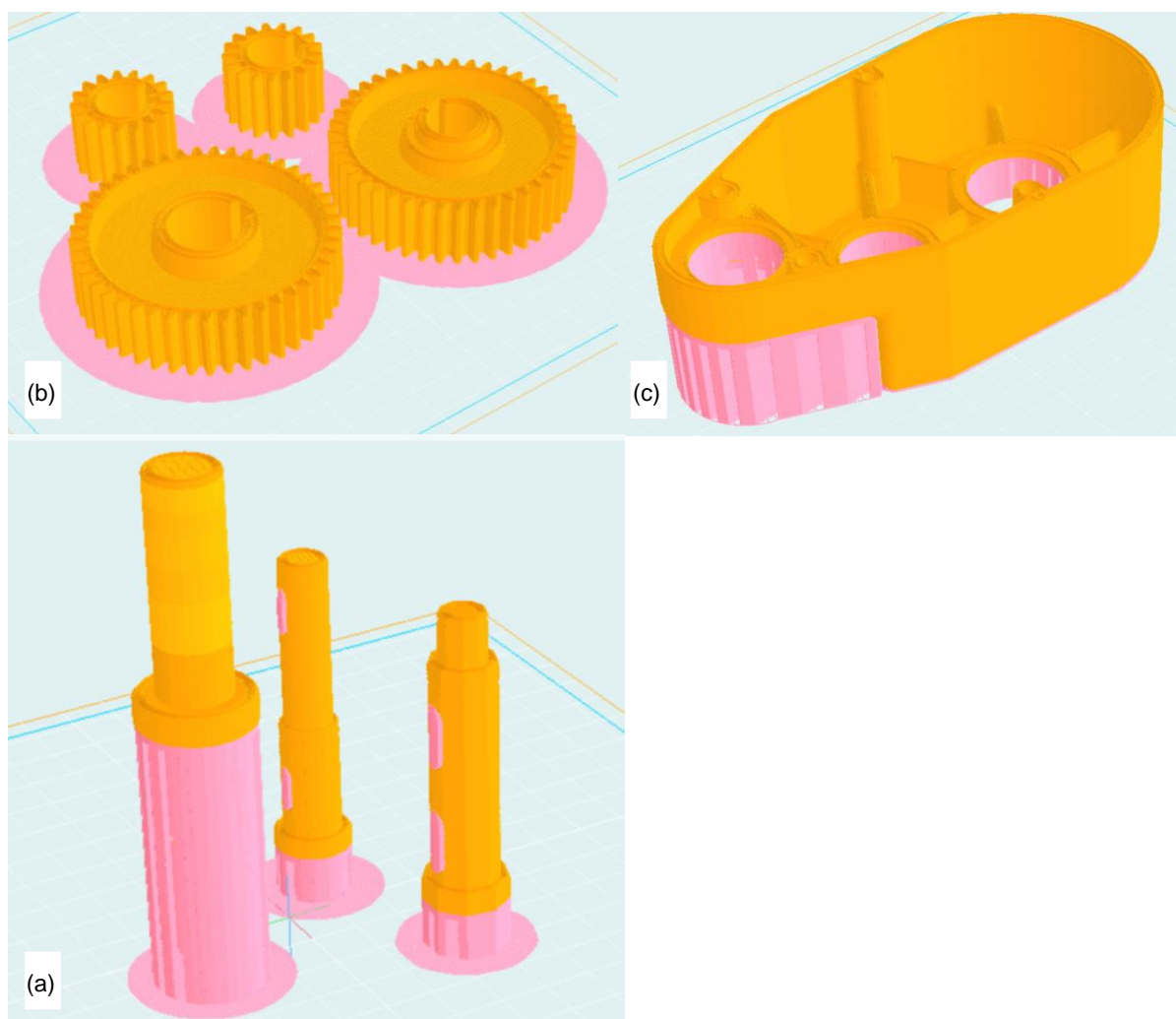
obr. 5-14 Podpory pro 3D tisk; (a) hřídelí; (b) ozubených kol; (c) jedné části převodové skříně
