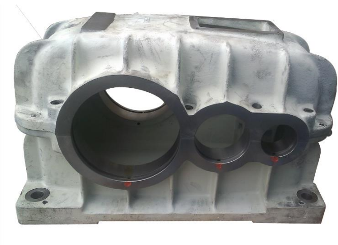
obr. 2-4 Převodová skříň dělená s rovině os hřídelí [21]
