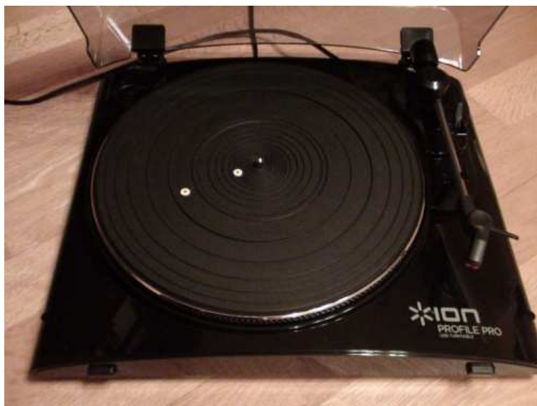
Obrázek 4.12: Využití gramofonu pro demonstraci rovnoměrného pohybu po kružnici.
