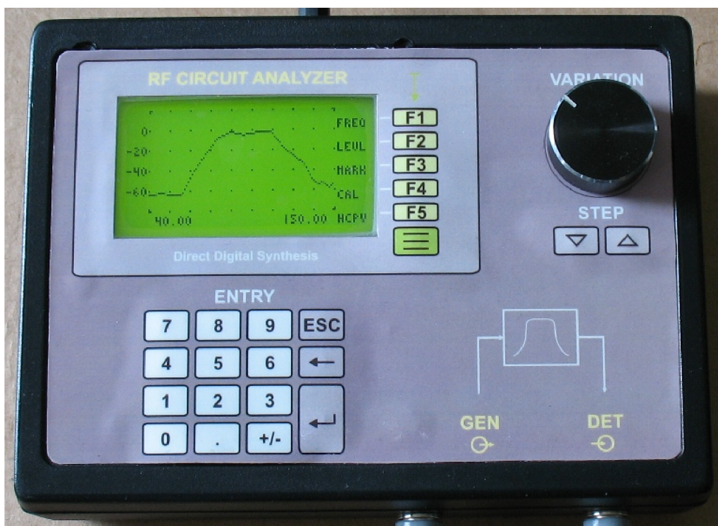
Obr. 2.7: Celkový pohled na zhotovený analyzátor.
