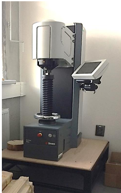
Obr. 15. Tvrdoměr Duravision-30 pro měření tvrdosti podle Brinella (foto autor)
