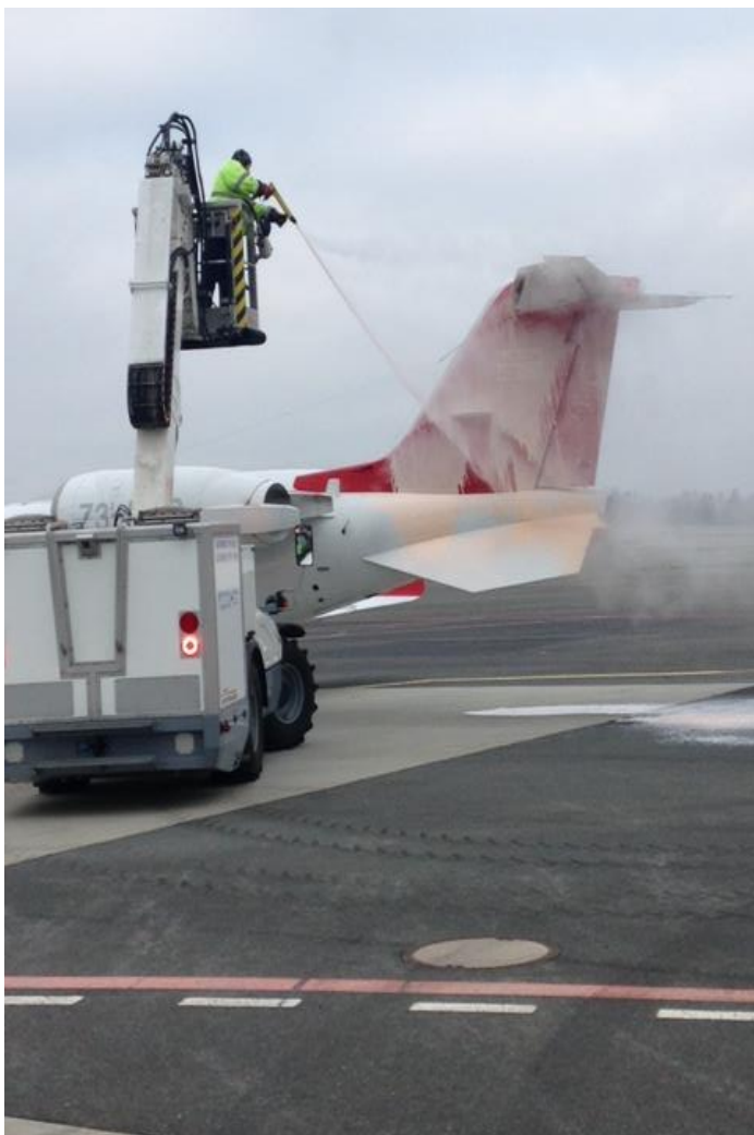
Obr. 10: Odmrazování kapalinou typu I. (Hlaváč, 2016)
