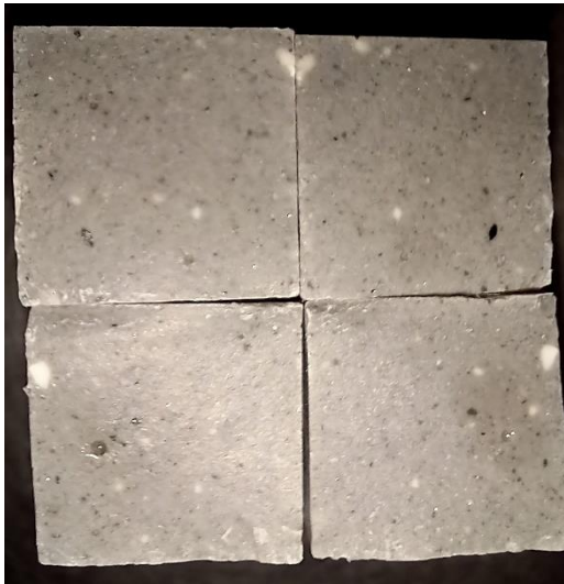
Obr. 58: Snímek vzorků pro mechanické testy obsahující 4 % \text{Ca}^{2+} ve formě CN- 28. den od počátku hydratace
