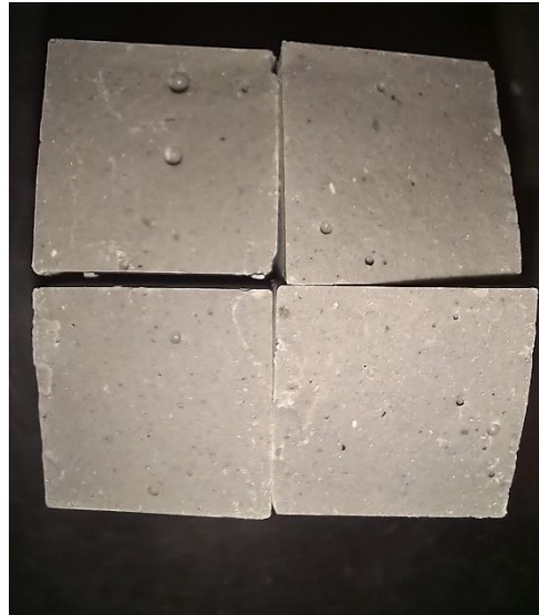
Obr. 56: Snímek vzorků pro mechanické testy reference- 1 den od počátku hydratace
