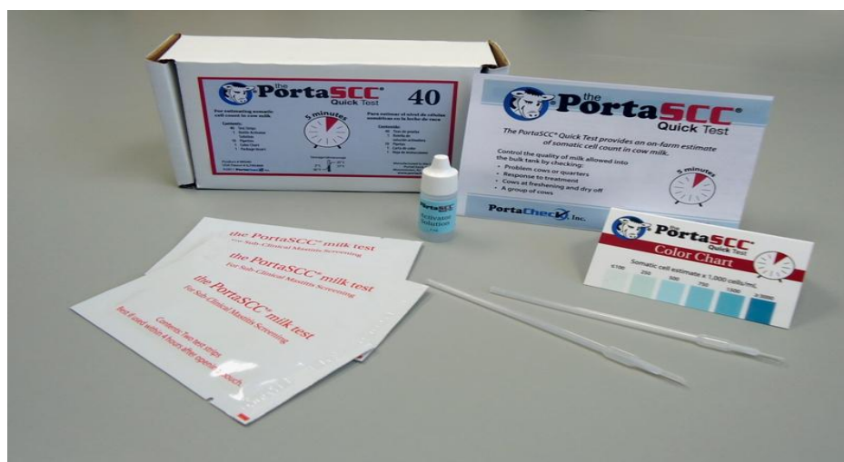
Obrázek 4: Testovací proužky, reagentie, pipety a barevná škála pro vizuální odhad počtu somatických buněk u The Porta SCC quick test ( http://www.portacheck.com/portasc.php )
