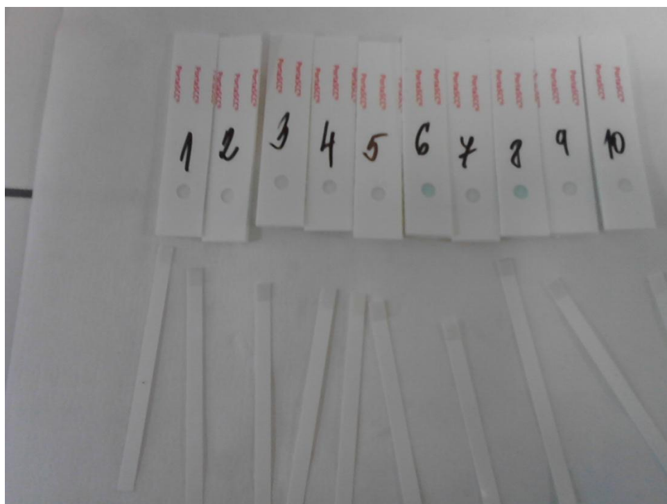
Obrázek 5: Testovací proužky pro The Potra SCC milk test po nanesení vzorku mléka a reagentie a po uplynutí 45 minut (nahore), testovací proužky s reagenčním polštářkem The Udder check test poté, co byly ponořeny do mléka a uplynutí 2 minut (dole)
