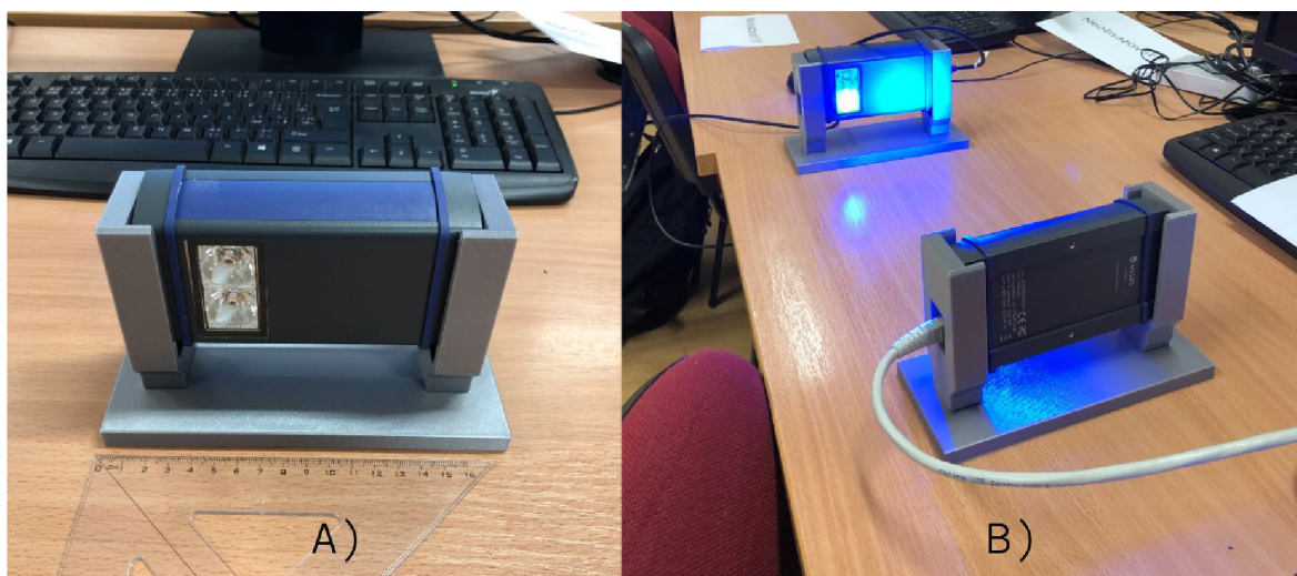
Obr. 14 Zařízení TruLiFi 6013 A)vysílač/přijímač B)přenos mezi vysílačem a přijímačem (Zdroj: (vlastní))
