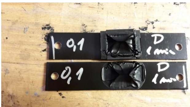
Obrázek 7: Testování quickfix efektu po jedné minutě od slepení. Zdroj: Vlastní zpracování.
