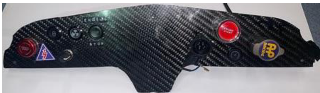
Obrázek 26 přístrojový panel monopostu FS6 [archiv autora]
