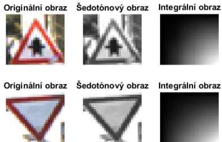
Obr. 2.15 Ukázka RGB, šedotónového a integrálního obrazu
