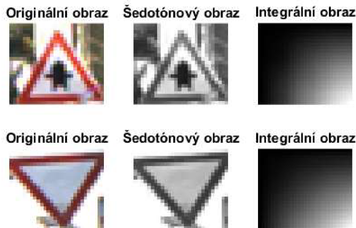
Obr. 2.15 Ukázka RGB, šedotónového a integrálního obrazu
