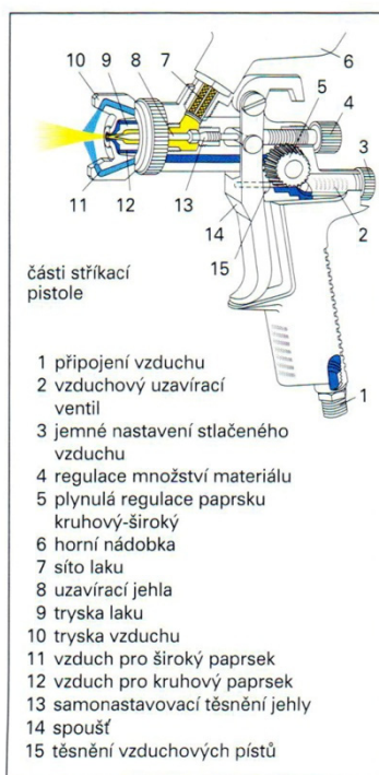
Obr. 1 Vysokotlaká stříkací pistole (Nutsch, 1999)
