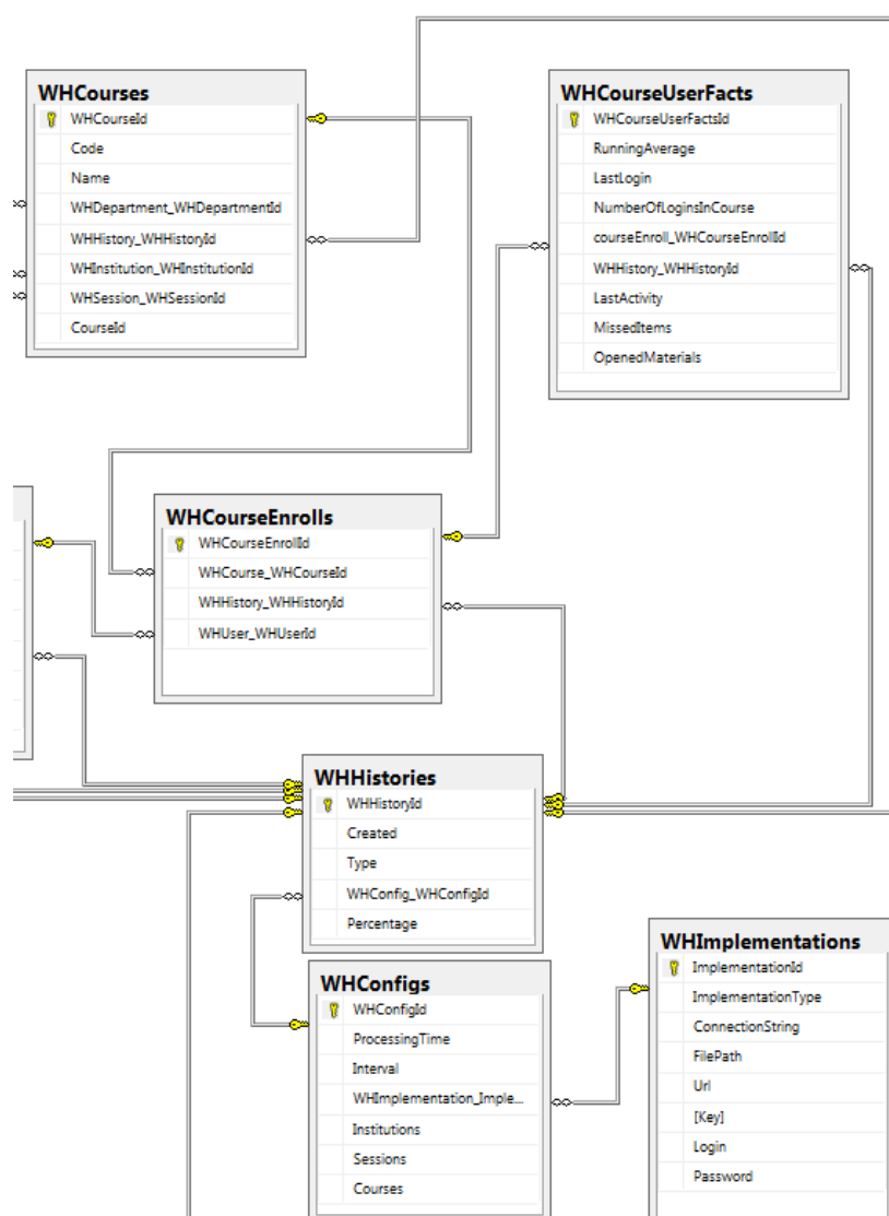
Obrázek A.1: Diagram datového skladu (nedůležitá část vlevo je ořezána). Vektor rysů je uložen v tabulce WHCourseUserFacts.
