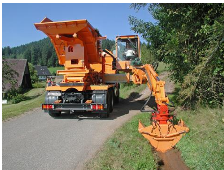
Obrázek 5: Čištění za pomoci stroje Mulag HS 2400 [6]
