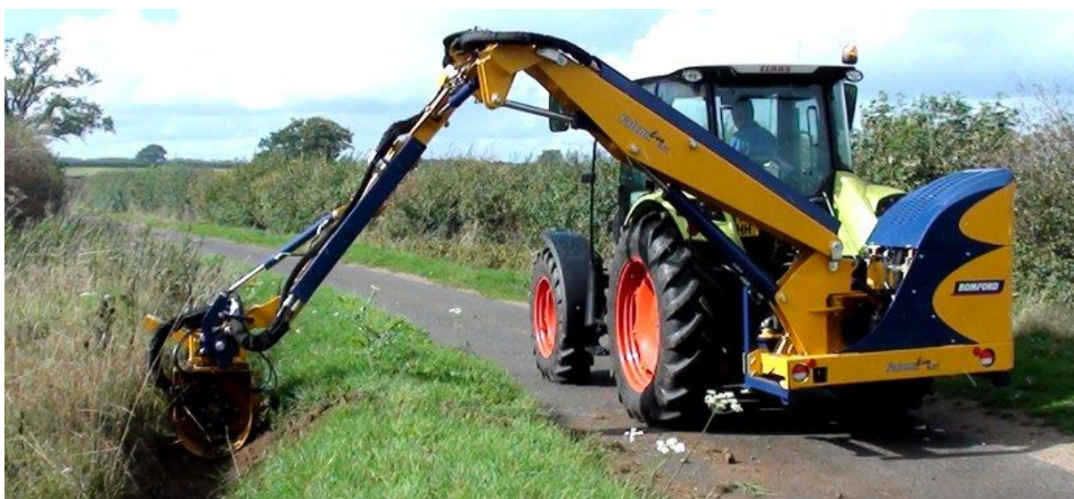
Obrázek 1: Příklad údržby příkopů pomocí zadně agregované příkopové frézy [1]
