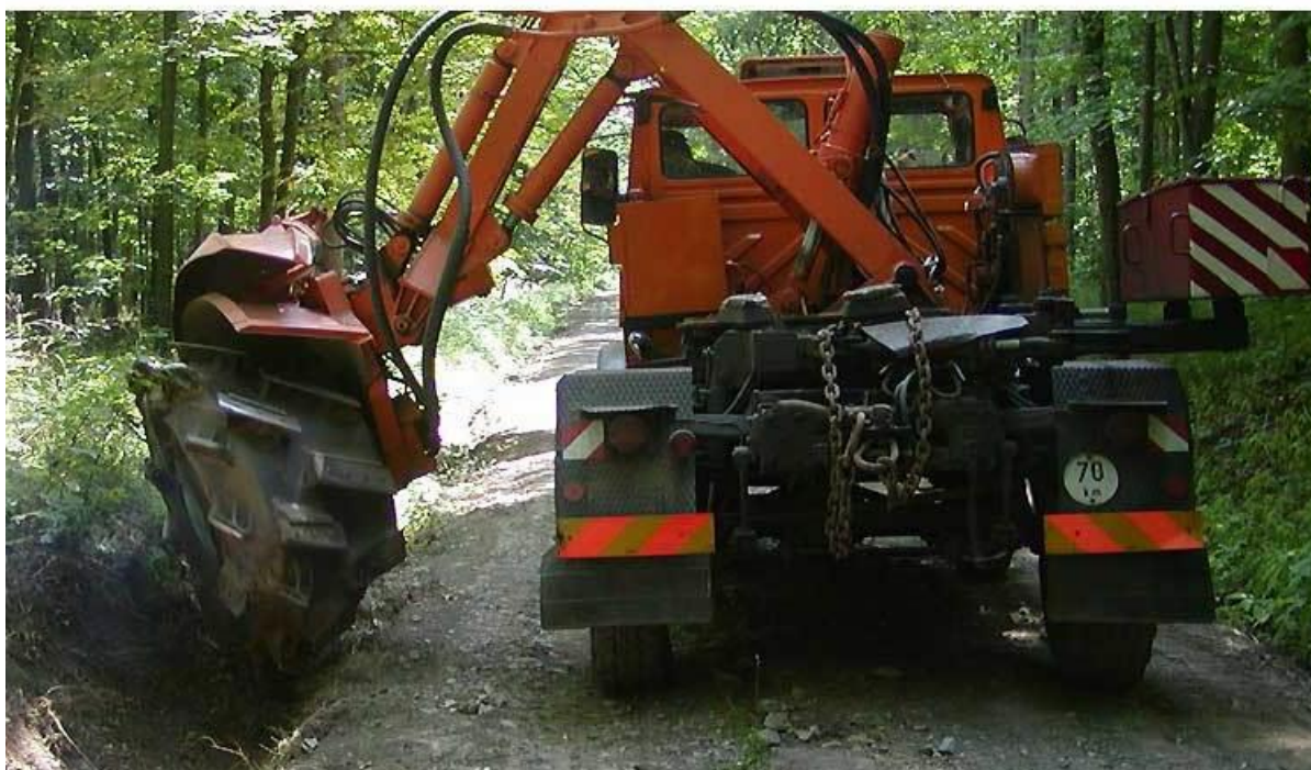
Obrázek 6: Příklad radiální frézy, nosný stroj Mercedes Unimog [7]
