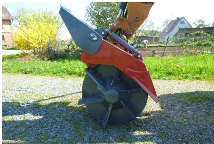
Obrázek 19: Příklad frézy s hydraulicky nastavitelným krytem. (Pzn – nejedná se o frézu určenou k čištění příkopů, ale k tvoření strouh v zemědělství – principiálně je stejná, ale mohutnější) [21]
