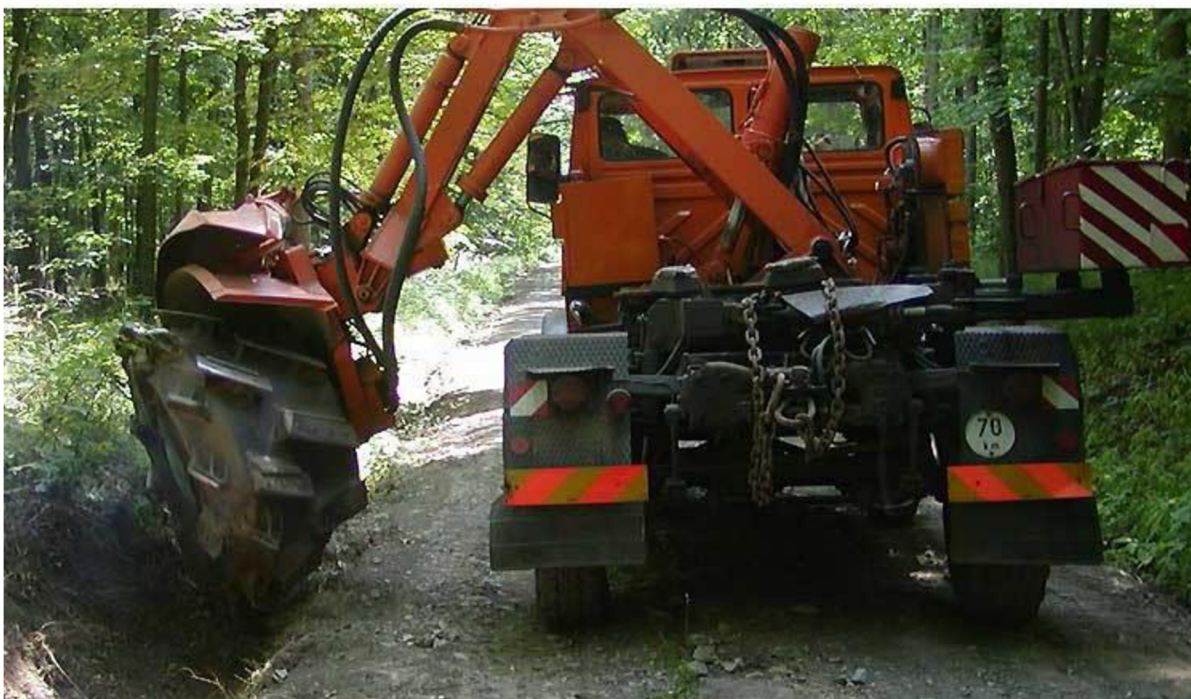
Obrázek 6: Příklad radiální frézy, nosný stroj Mercedes Unimog [7]
