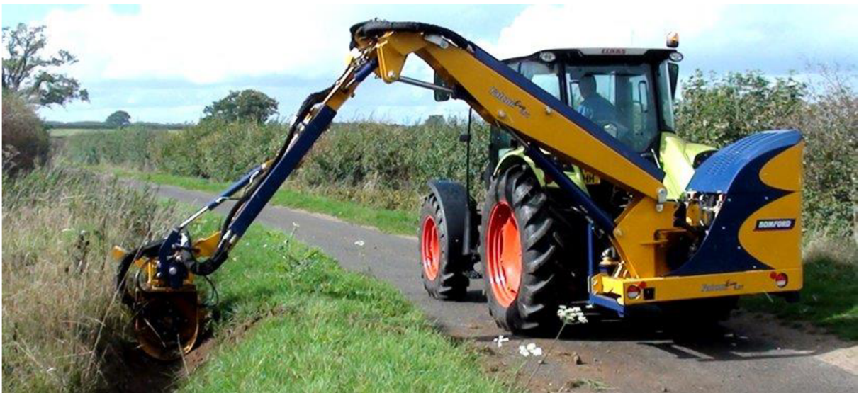
Obrázek 1: Příklad údržby příkopů pomocí zadně agregované příkopové frézy [1]
