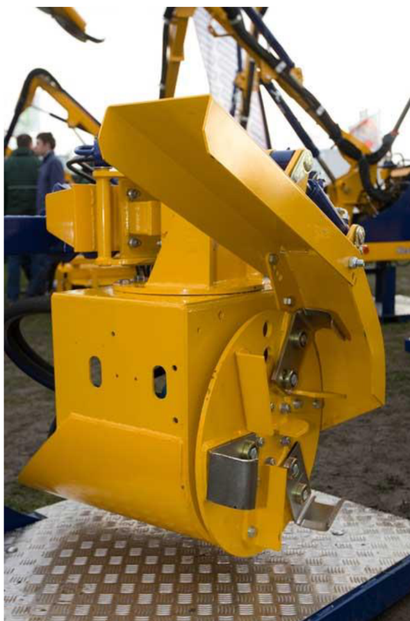
Obrázek 7: Příklad příkopové frézy s rovnoběžnou osou rotace k ose příkopu [8]
