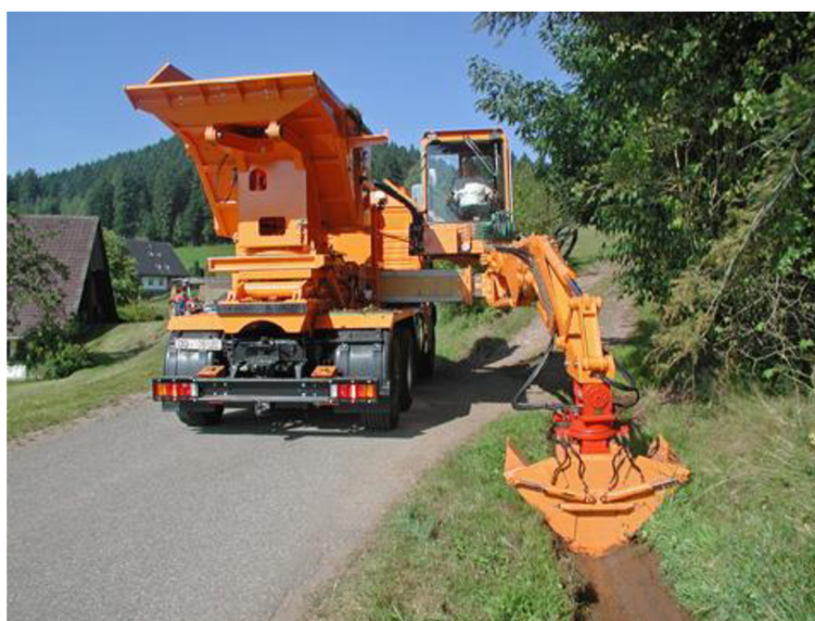
Obrázek 5: Čištění za pomoci stroje Mulag HS 2400 [6]
