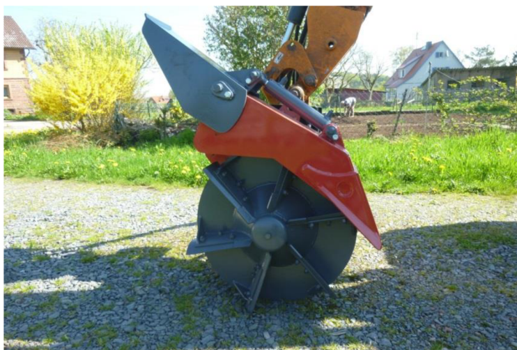
Obrázek 19: Příklad frézy s hydraulicky nastavitelným krytem. (Pzn – nejedná se o frézu určenou k čistění příkopů, ale k tvoření strouh v zemědělství – principiálně je stejná, ale mohutnější) [21]
