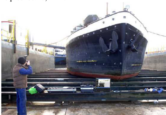
Obr. 22 Měření trupu lodě [17]
