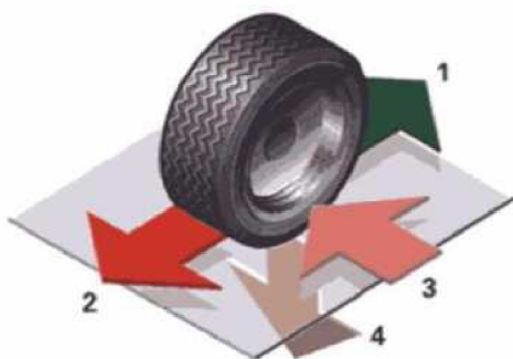
Obr. 3 Síly působící na kolo [7]
