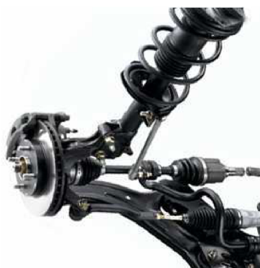
Obr. 2 Přední náprava McPherson [6]
