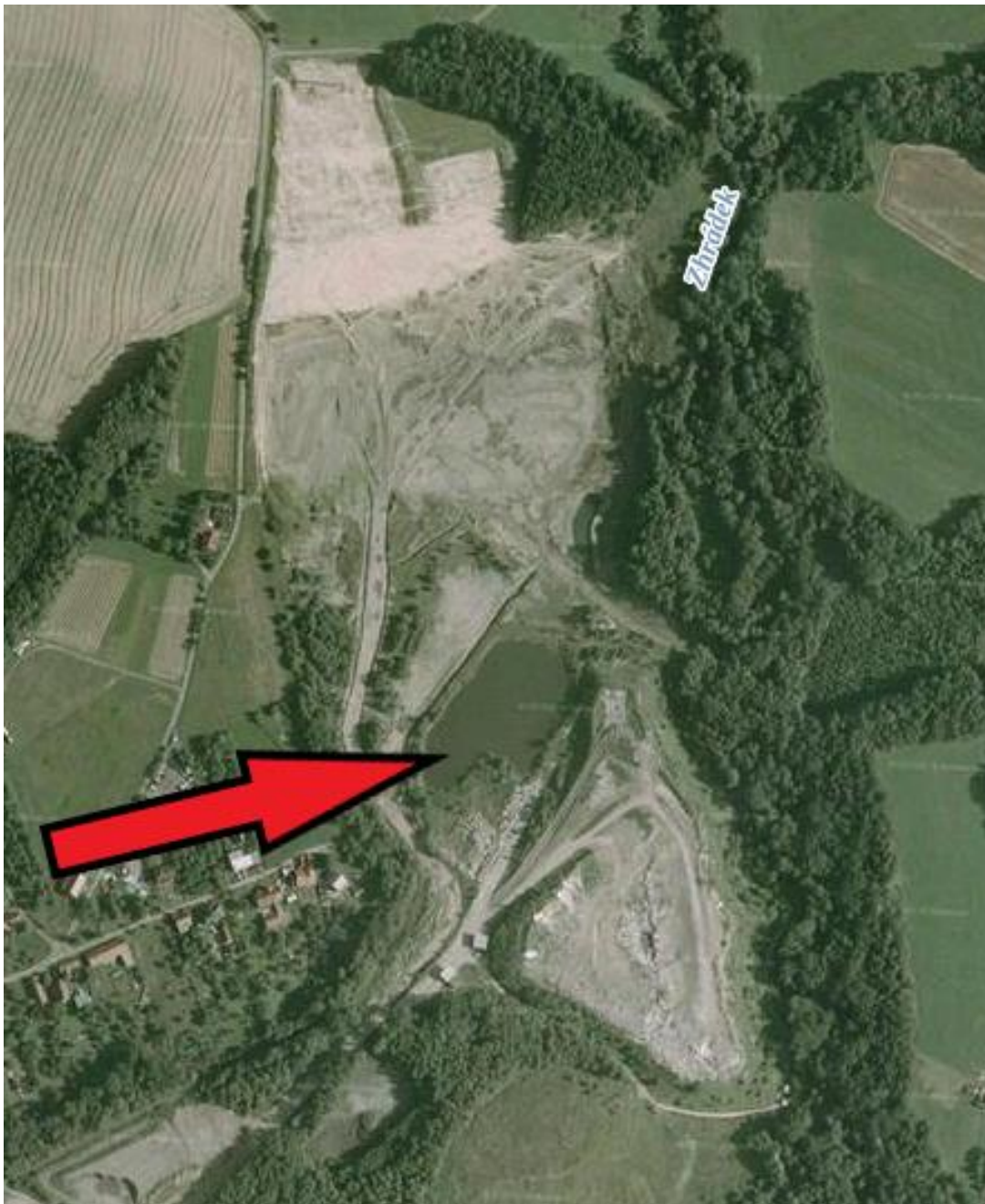
Obr. 12 Těžební plocha a skládka před rekultivací v r. 2003 s původním jezerem o rozloze 17 000 m 3 , které bylo v rámci rekultivace zasypano. (zdroj: mapy.cz)
