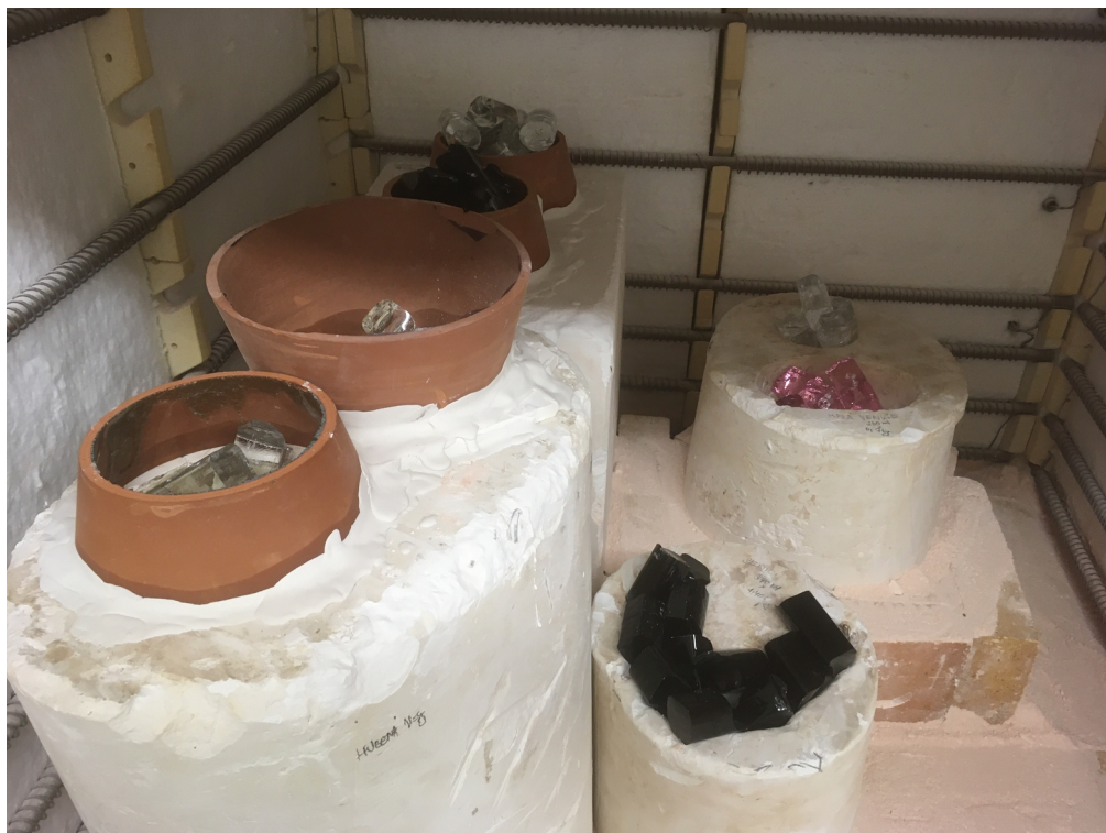
Obrázek 20: Připravené formy v peci [26]
