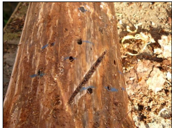
Obr. 18 Kukelné komůrky na špalku, který byl zakopán od 31. 5. do 31. 10. 2014 v lokalitě Špičák
