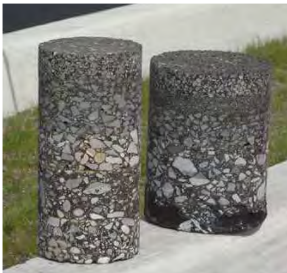
Obrázek 25 Jádrové vývrty z asfaltové vozovky [79]
