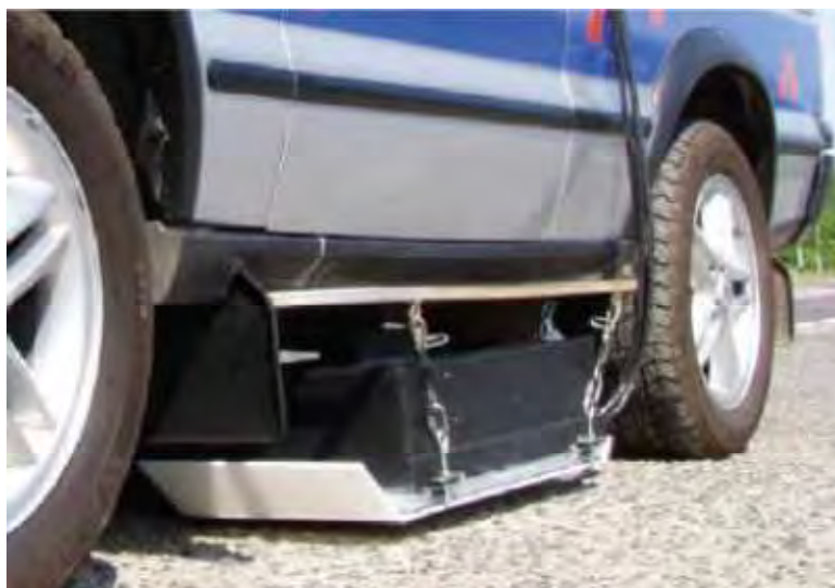
Obrázek 10 Příklad georadaru pro použití v diagnostice vozovek pozemních komunikací s ground-coupled anténou [49]
