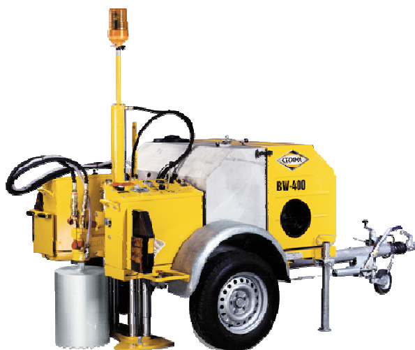
Obrázek 24 Zařízení pro odběr jádrových vývrťů z vozovky – Cedima BW-400 [78]
