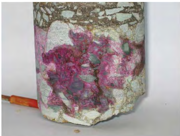
Reakce fenolftaleinu na jádrovém vývrtu
