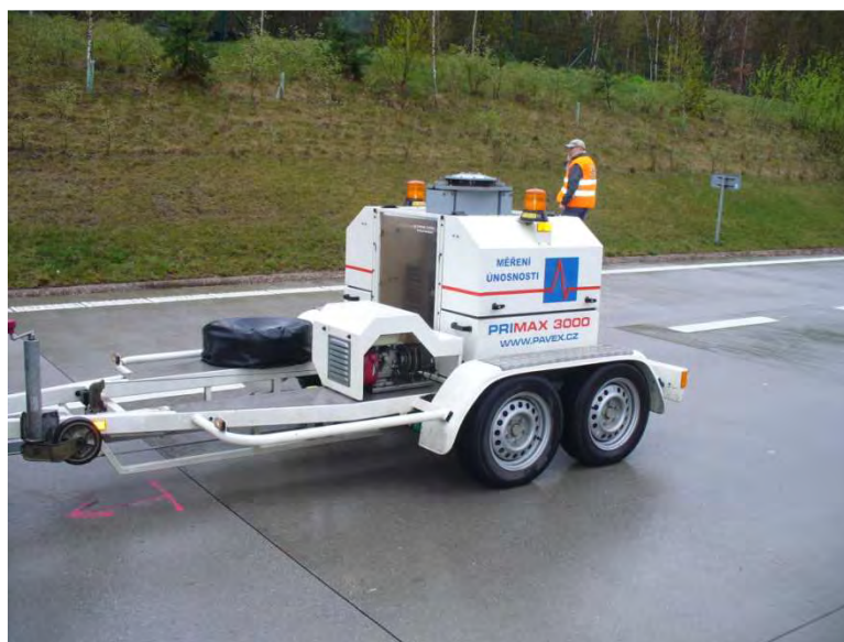
Obrázek 12 Rázové zatěžovací zařízení FWD používané v ČR firmou PavEx Consulting, s.r.o.
