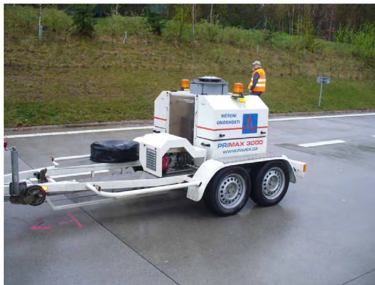
Obrázek 12 Rázové zatěžovací zařízení FWD používané v ČR firmou PavEx Consulting, s.r.o.
