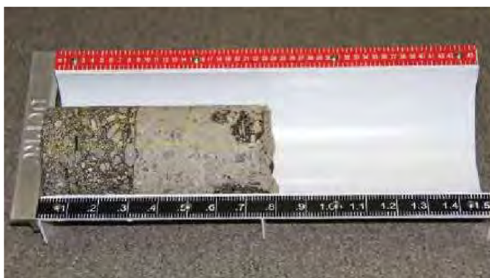
Obrázek 22 Přípravek pro orientační měření jádrových vývrtů a jejich fotodokumentaci [49]
