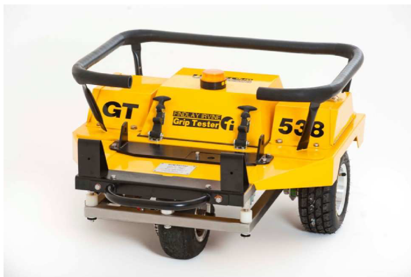
Obrázek 14 Griptester – zařízení na dynamické měření protismykových vlastností vozovek [72]
