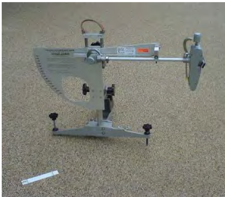
Obrázek 15 Zařízení pro měření hodnoty PTV – Pendulum Test Value [73]
