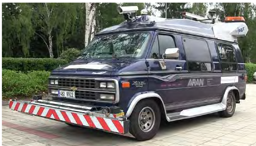
Obrázek 20 Multifunkční vozidlo pro monitoring parametrů vozovek ARAN [62]
