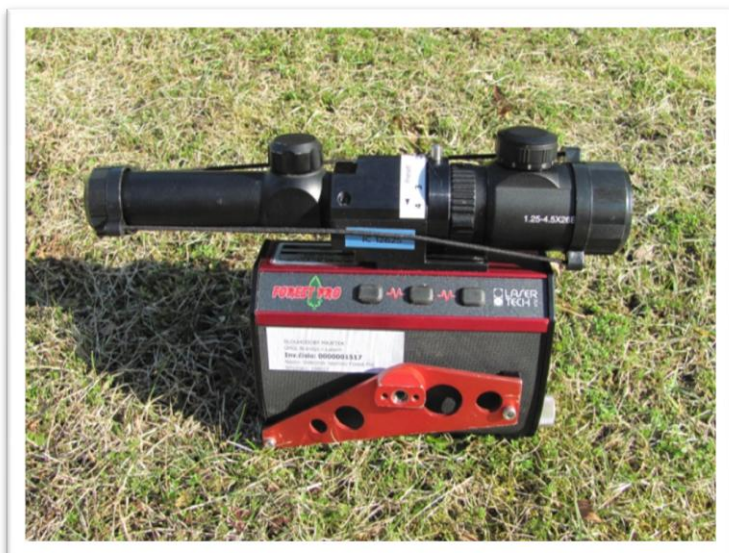
Obrázek 2: Laserový dálkoměr, sklonoměr a výškoměr ForestPro
