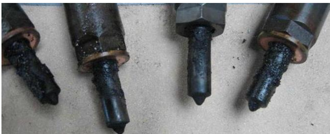
Obr. 9: Karbonové usazeniny na vstříkovacích tryskách [41].
