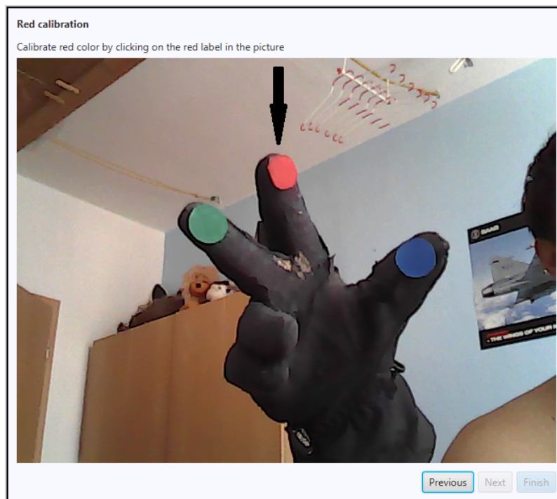
Obrázek 9: Ukázka kalibrace červené barvy s označeným červeným terčem
