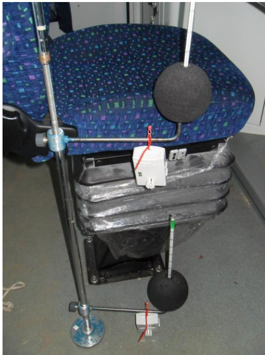
Obr. 3: Měření výsledné teploty kulovým teploměrem Vernon-Jokl a teploty a vlhkosti vzduchu datalogerem ve výšce a) kotníků a břicha, b) ve výšce hlavy strojvedoucího
