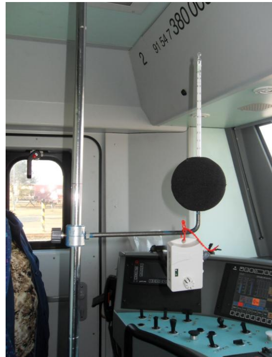
Obr. 3: Měření výsledné teploty kulovým teploměrem Vernon-Jokl a teploty a vlhkosti vzduchu datalogerem ve výšce a) kotníků a břicha, b) ve výšce hlavy strojvedoucího
