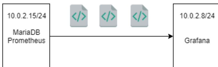
Obrázek 17: Schéma systému pro analýzu aktivity uživatele databáze
