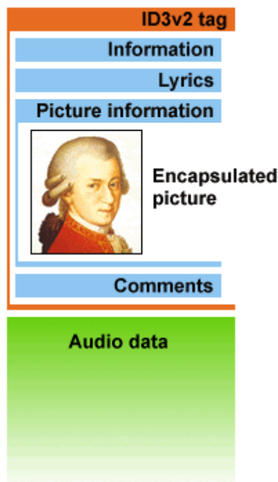
Obrázek 2.3: Přibližná podoba souboru obsahující ID3v2 tag. Hlavní změnou oproti předchozí verzi, je výskyt tagu na začátku souboru, před zvukovými daty. Jednotlivých položek (rámců) může být obsaženo mnohem více a s proměnlivou délkou. Převzato z [10].
