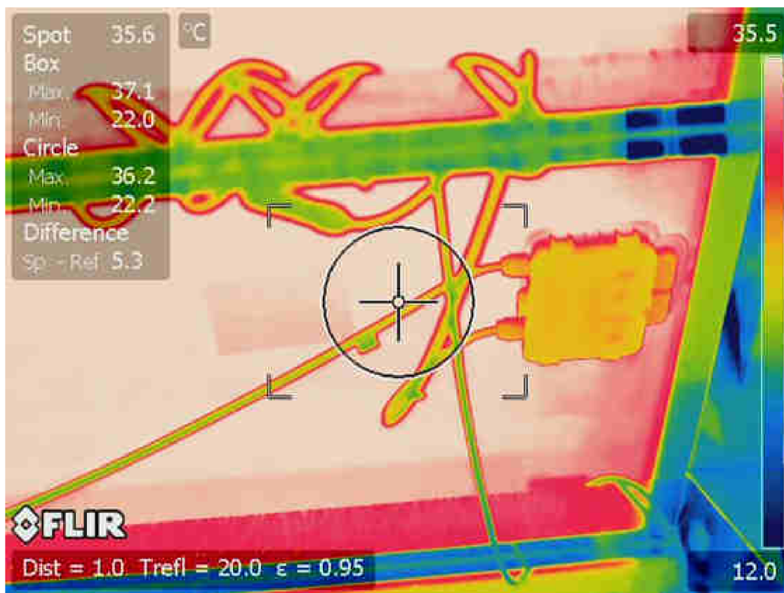
Obr. 5.2-8 Snímek připojovacího boxu a konektorů FV modulu 2.8
