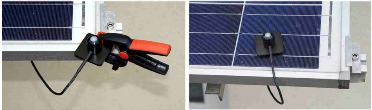
Obr. 4.3-1 Příklad správného a chybného umístění snímače ozáření [35]
