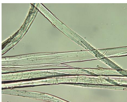
Obrázek 14- Mikroskopický pohled na polyesterové vlákno (PL) s nekruhovým průřezem
