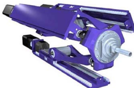
Obr. 3-9: Obráběcí jednotka SPIRIT Z3 na bázi tripodu[17]
