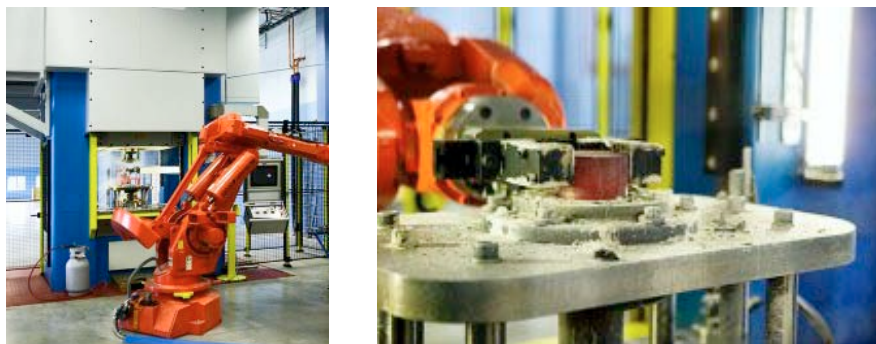
Obr. 2-8: RTP pro tváření – průmyslový robot obsluhující hydraulický lis[10]
