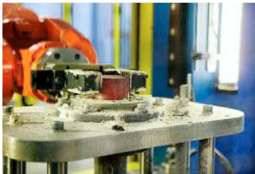
Obr. 2-8: RTP pro tváření – průmyslový robot obsluhující hydraulický lis[10]
