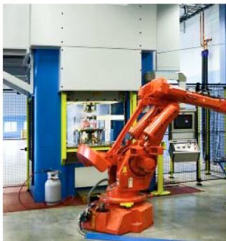
Obr. 2-8: RTP pro tváření – průmyslový robot obsluhující hydraulický lis[10]
