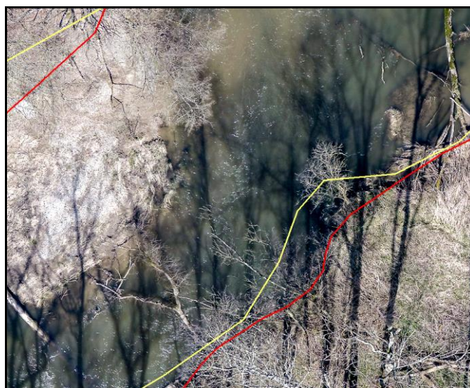
Obr. 23 Břehová eroze na levém břehu na snímku z roku 2018 – žlutě je označena břehová linie z roku 2014 a červeně břehová linie z roku 2018
