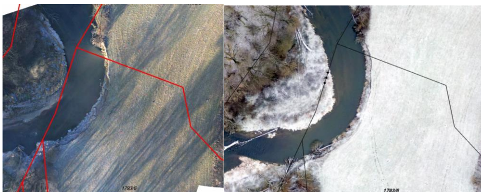
Obr. 31 Problém v katastru způsobený boční erozí (vlevo snímek 2011 (Miřijovský, 2013), vpravo snímek 2018; podklad – snímky KGI, WMS Katastrální mapy ČÚZK)
