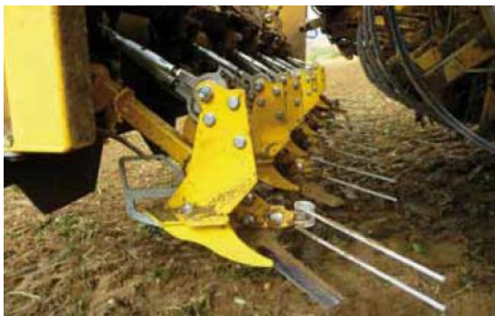
Obr. 11 Micro-Topper 2 s novou automatikou seřezu (zdroj: http://www.cukr-listy.cz/on_line/2011/PDF/394-396.pdf )
