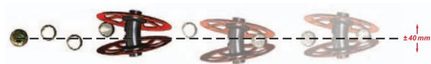
Obr. 21 Navádění kotoučového vyorávacího ústrojí (zdroj: http://static.prod.grimme.com/files/2014/10/17/f3640f6bfdb39c5bb796911c241580cfee35084f.pdf )
