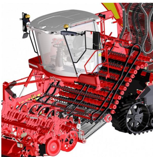
Obr. 31 Čistící a dopravní ústrojí sklizeče Grimme Maxtron 620 (zdroj: http://www.grimme.com/de/media )
