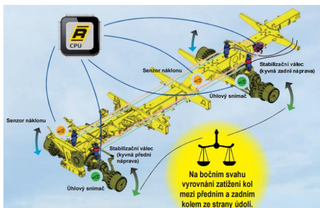
Obr. 23 Hydraulický vyrovnávací systém zatížení kol (zdroj: https://www.ropa-maschinenbau.de/en/download/prospekte )
