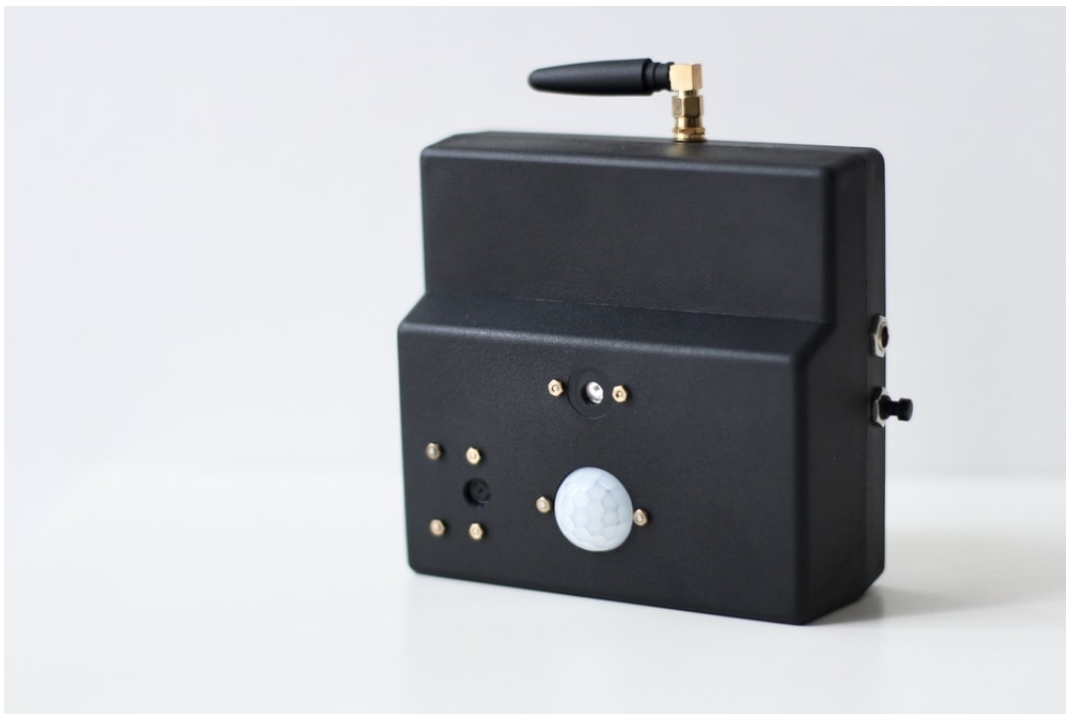
Obr. 4.1: Realizace kamerového zabezpečovacího systému
