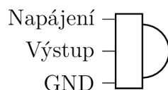
Obr. 1.5: Schéma PIR modulu
