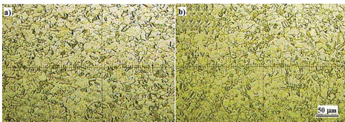
Obrázek 23: Struktura oceli typu a (a) a B (b) před deformací. [43]
