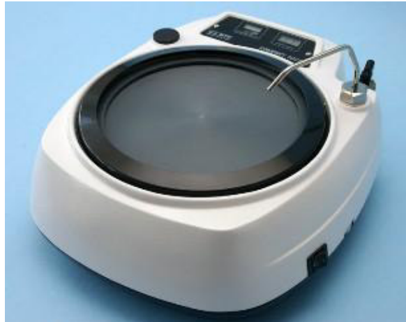
Obrázek 30: Metalografická bruska MTH Kompakt 1031. [49]
