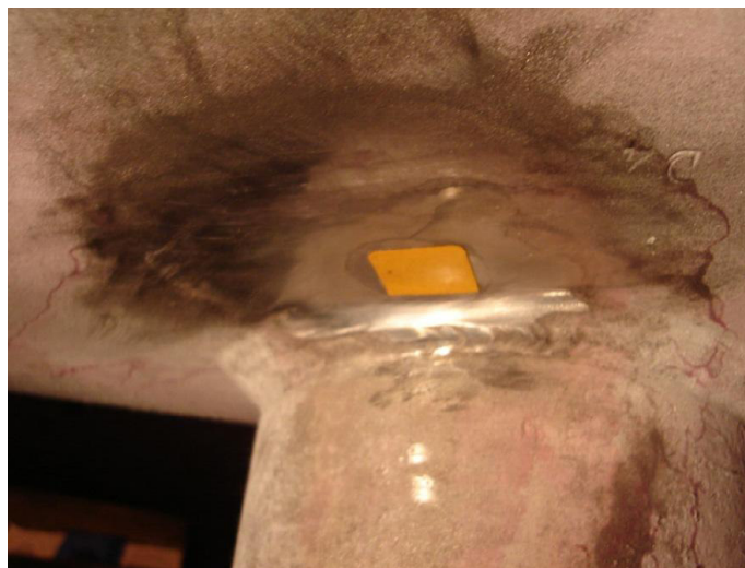
Obrázek 18: Replika aplikovaná na připravený povrch. [39]
