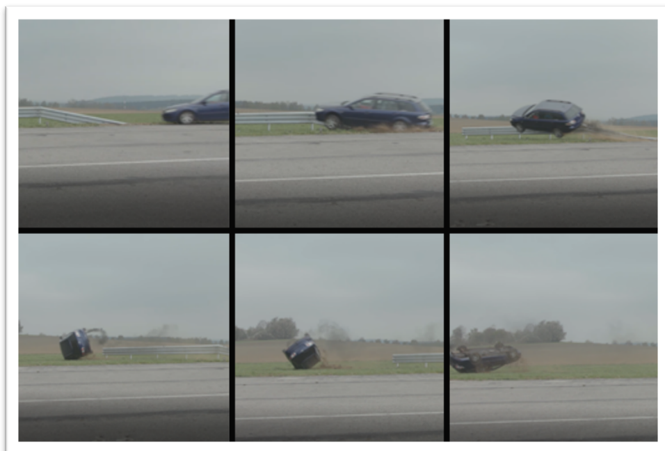
Obrázek 11: Ilustrace standardního řešení výškového náběhu a reakce vozidla po kolizi s náběhem
