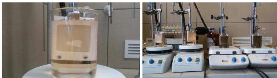
Obr.13: Snímek polymeračního roztoku s nesmočeným vzorkem v teflonovém rámečku a snímek smočených vzorků během polymerační reakce dopaminu.
