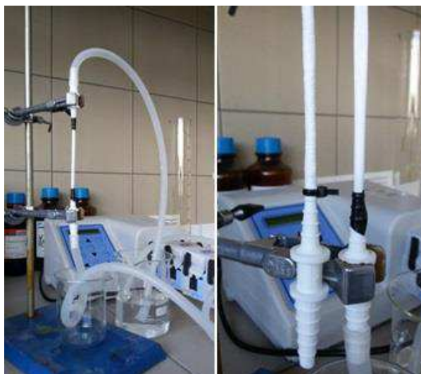
Obr.14: Snímek uchycení tubulárních vzorků při modifikaci polydopaminem a heparinem.
