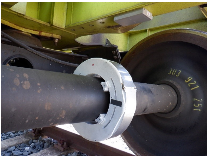
Obr. 2.20 Příklad umístění GPS zařízení na dvojkoli
