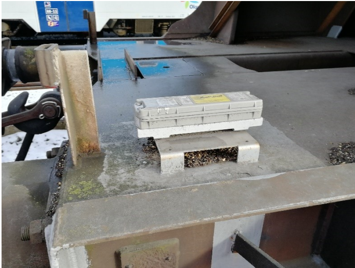
Obr. 2.22 Příklad umístění GPS na podlaze vozu
