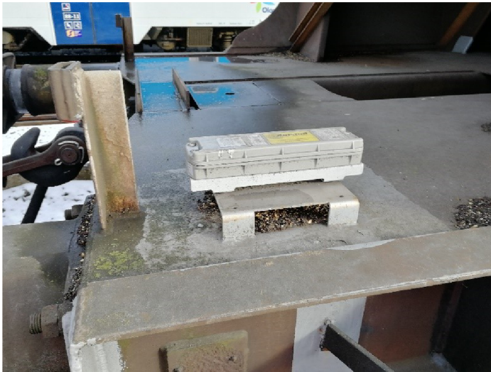
Obr. 2.22 Příklad umístění GPS na podlaze vozu
