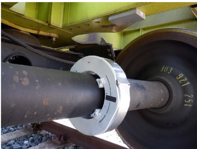
Obr. 2.20 Příklad umístění GPS zařízení na dvojkolí
