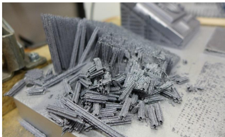
Obrázek 21: Odstraňování podpor dílu s úhlem naklonění 30 stupňů
