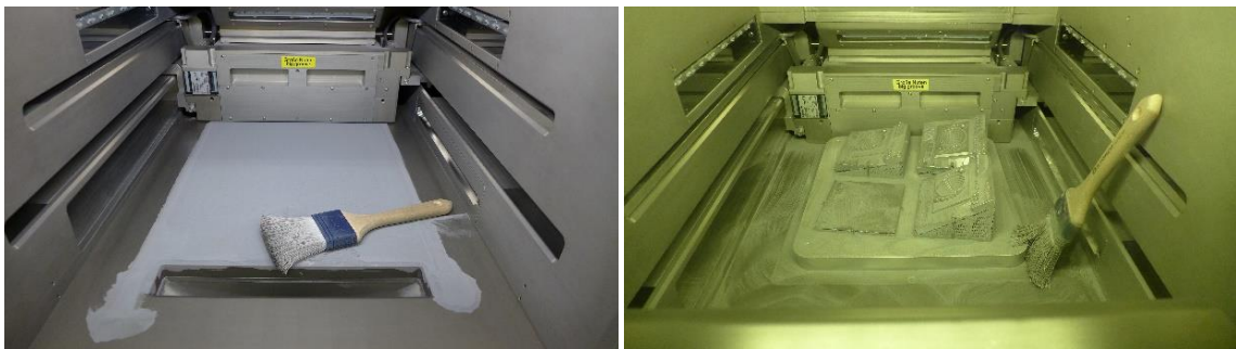
Obrázek 19: Komora tiskárny SLM 280HL před a po tisku
