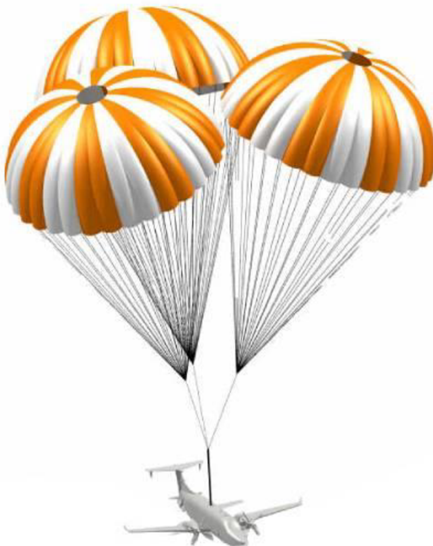
Obr. 39: 3D model balistického záchraného systému pre Beechcraft 1900
