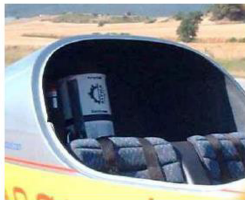
Obr. 13: Umiestnenie záchranného systému v lietadle [9]
