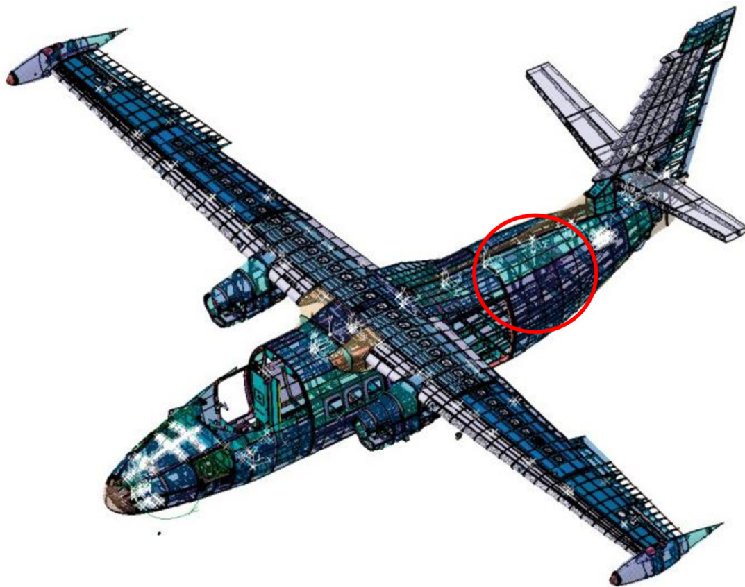
Obr. 37: L-410 s vyznačením miestom na umiestnenie balistického záchranného systému [17]
