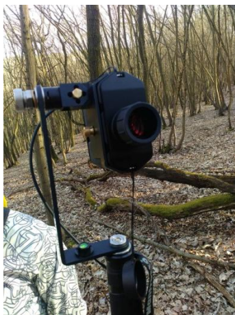
Obrázek 8: Detail laserového dálkoměru, foto: Michaela Voitová
