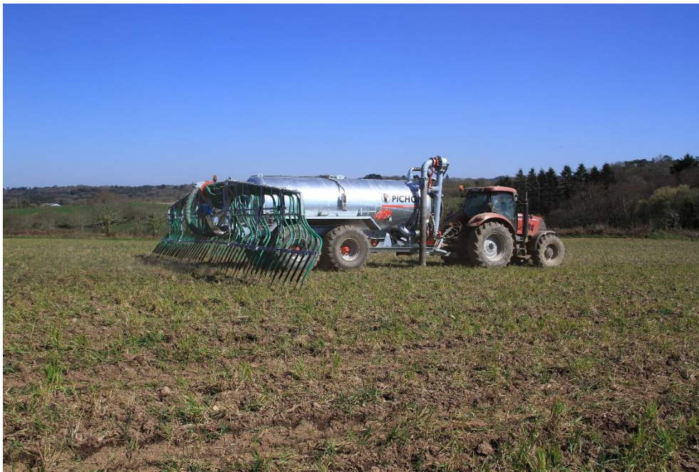
Obr. 9 Cisterna s hadicovým aplikátorem [13]
