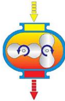
Obr. 20 Schéma Rootsové vývěvy [19]
