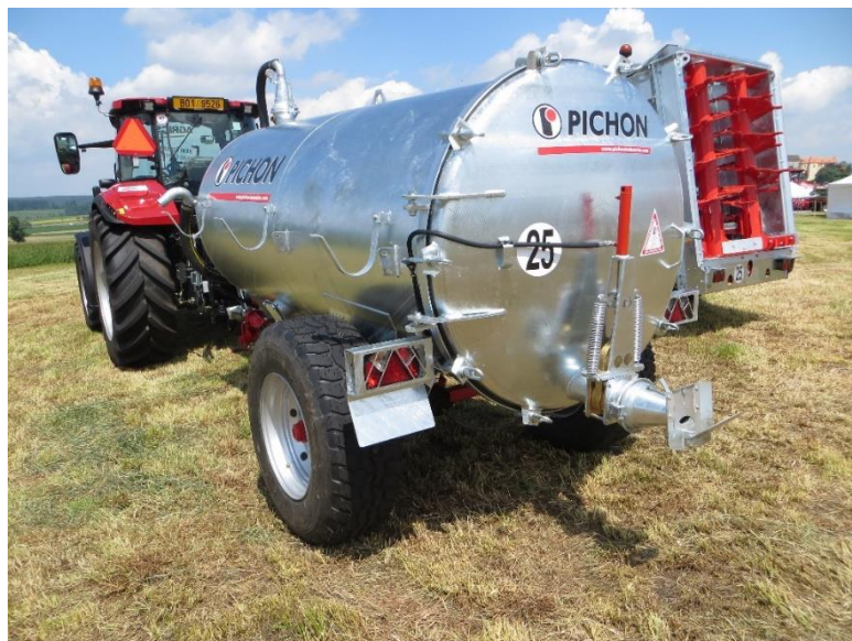
Obr. 7 Cisterna s vyprazdňováním pomocí nárazové hlavy [13]
