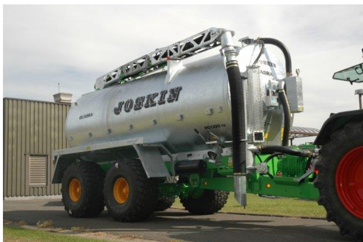
Obr. 35 Cisterna s pozinkovaným horním sacím ramenem [32]
