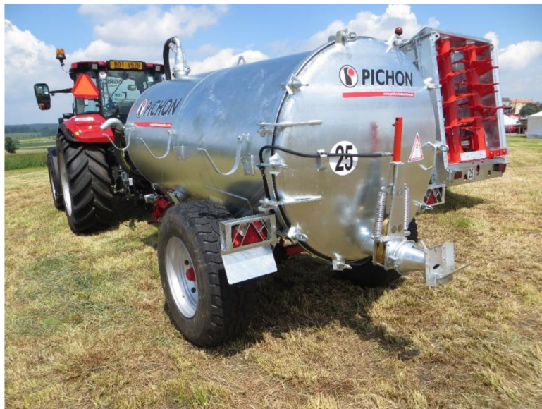
Obr. 7 Cisterna s vyprazdňováním pomocí nárazové hlavy [13]
