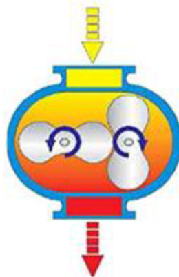
Obr. 20 Schéma Rootsovy vývěvy [19]
