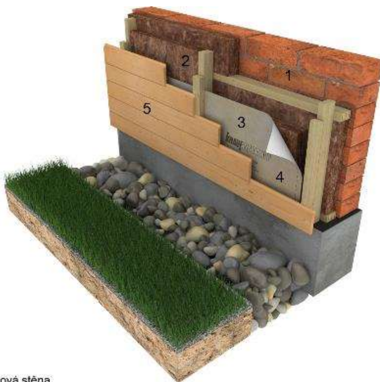
Obrázek 2 Jednotlivé prvky provětrávané fasády, Zdroj (14))
