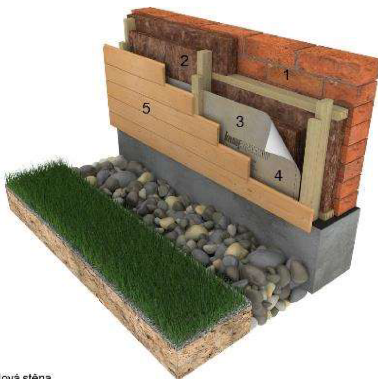
Obrázek 2 Jednotlivé prvky provětrávané fasády, Zdroj (14)
