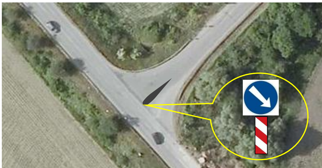
Obrázek 8: Fotomontáž navrhované úpravy dopravního ostrůvku [39]
