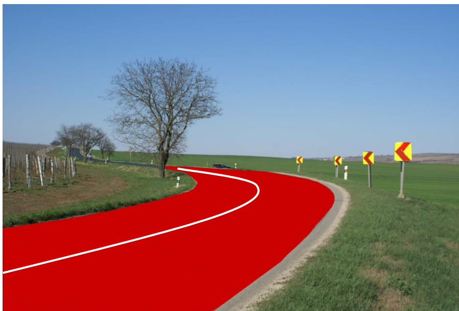
Obrázek 15: Fotomontáž navrhované úpravy povrchu systémem „Rocbinda“ [39]
